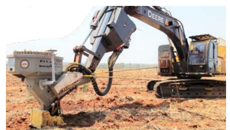
Illustration 1 : Récepteur GNSS AsterRx4 en fonction pour guider la plantation des arbres
