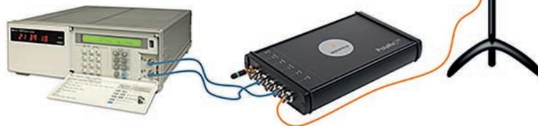
Éléments de base pour un laboratoire de transfert de temps : une horloge atomique CS, un récepteur temps PolRx5TR et une antenne
